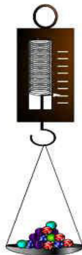
Figura 7. Balanza de resorte. Fuente:
