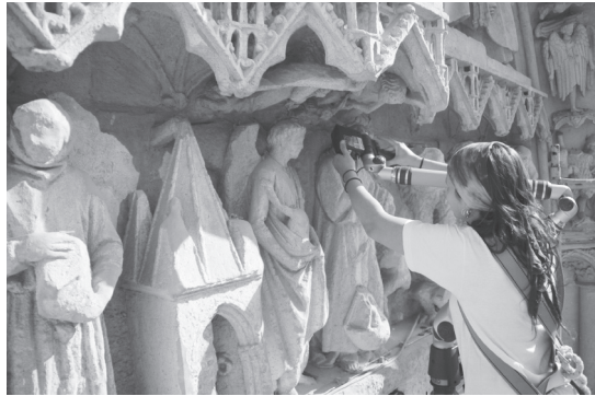
Técnica de escaneado en 3D
